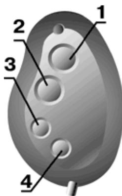
Четырехкнопочный брелок позволяет дистанционно управлять системой. С помощью брелока проводится постановка на охрану, снятие с охраны, управление режимами (отключение тревоги, поиск, паника), а также управление программируемыми каналами. Брелок является дополнительным элементом управления системой.
